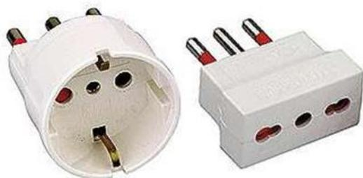
Figura 27. Adattatori: quello a sinistra per collegare una spina tedesca ad una presa italiana da 16 A; quello a destra consente di collegare ad una presa da 10 A una spina italiana sia da 16 A che da 10 A
