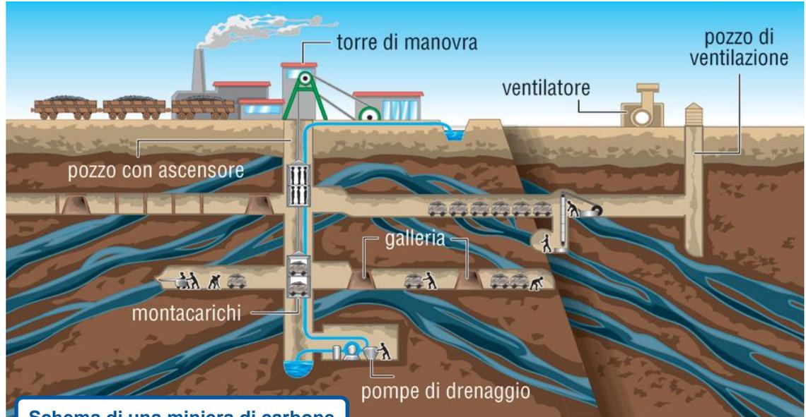
Schema di una miniera di carbone
